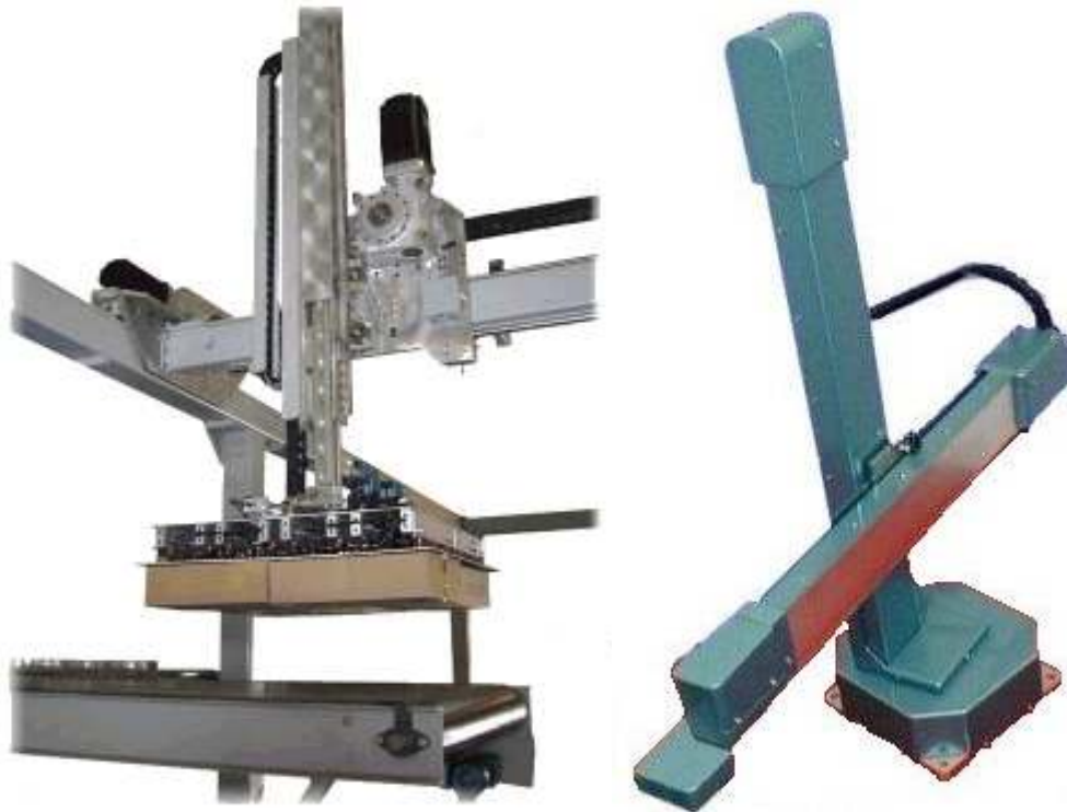
Figura 3.18 – Um robô do tipo pórtico (“gantry”), à esquerda, fabricado pela BMI, e um robô cilíndrico feito pela ST Robotics, à direita.
